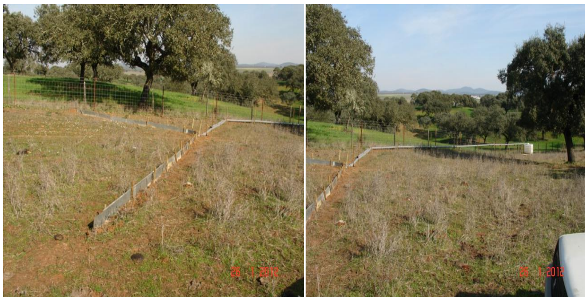
Foto 1.3. Instalação do 3º talhão de erosão
