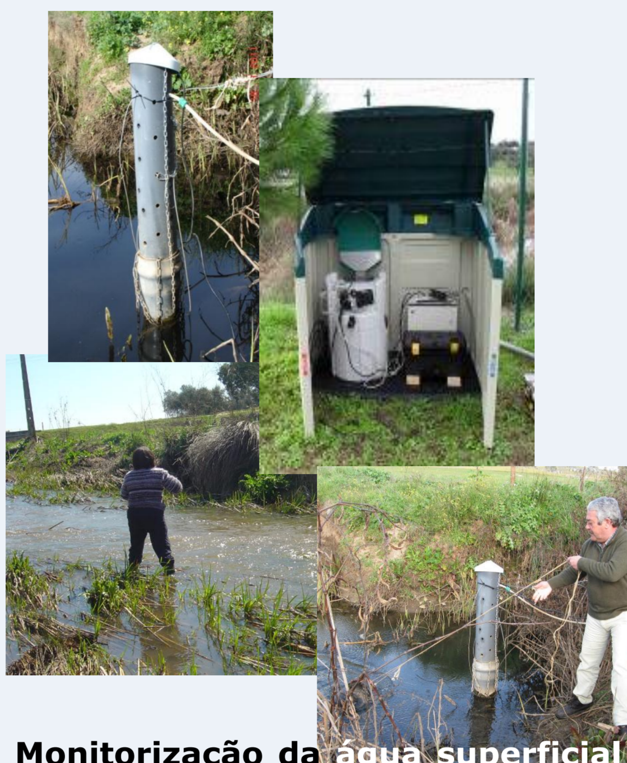
Monitorização da água superficial da ribeira do Enxoé, automática e manualmente em 2 locais e 3 repetições, a montante da albufeira do Enxoé
